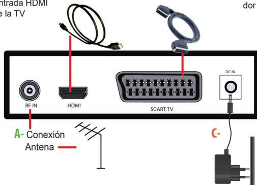
**C- REGLAS DE SEGURIDAD:** solo después de todas las conexiones: conecte la fuente de alimentación a la entrada DC IN en el decodificador y, a continuación, conéctelo a la toma de corriente.
